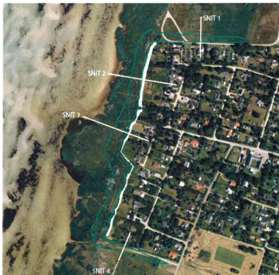
Figur 24 Oversigtstegning af grøftens udbredelse med anlæg 1:5 og 1:3. Digets udbredelse er markeret med en grøn afgrænsning, grøften med grå. På tegningen er markeret placering af tværsnit jf. figur 35
