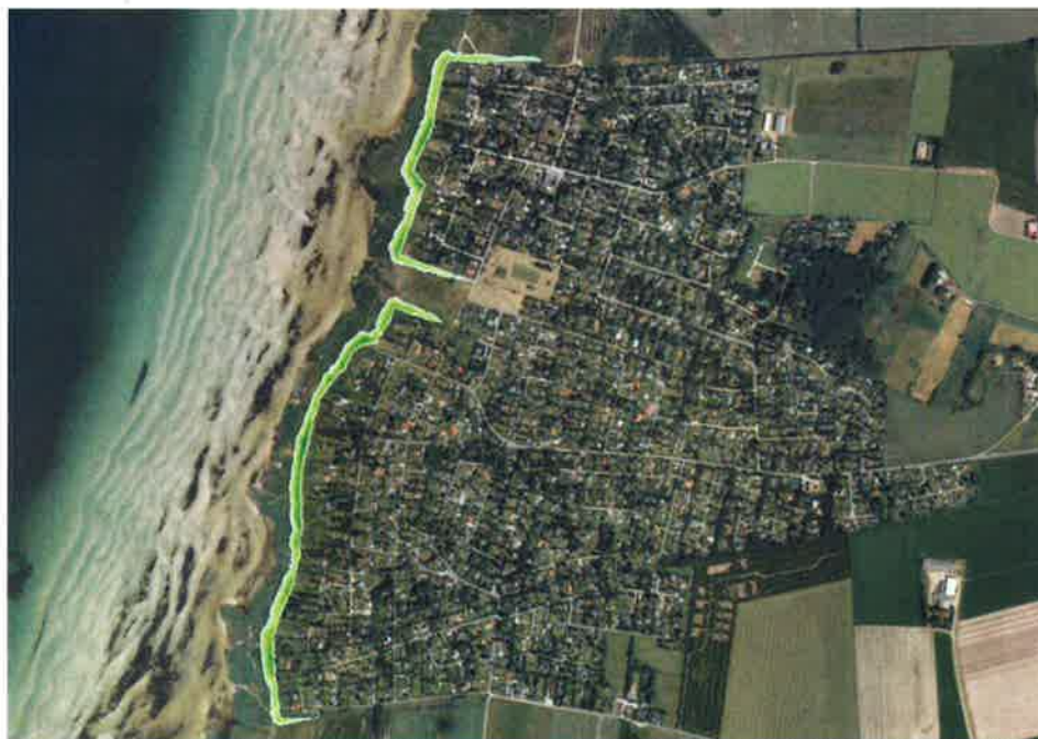
Figur 23 Oversigtstegning digets udbredelse med anlæg 1:10 og 1:5. Over Dråby Strand 2050 (2,99 m DVR90).
